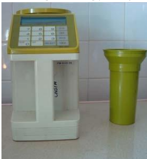
Hình 5.6. Máy kiểm tra độ ẩm hạt tiêu
